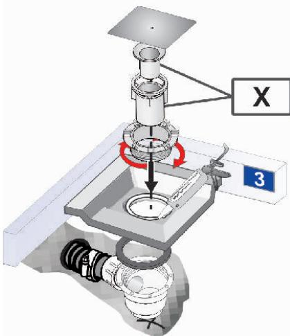
En caso de existir bote sifónico en la vivienda se eliminará el sifón del desagüe (piezas X).
